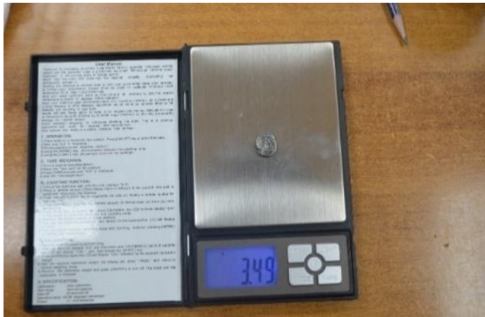
اللوحة ٢: صورة تبين الميزان الرقمي المستخدم في قياس اوزان قطع الدراسة
